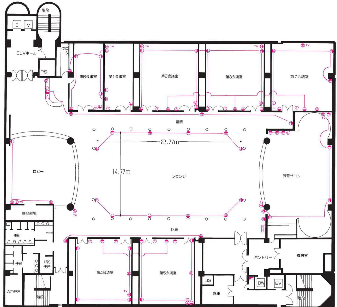
※電気容量 (・赤ライン 1回路 1.8Kw)
